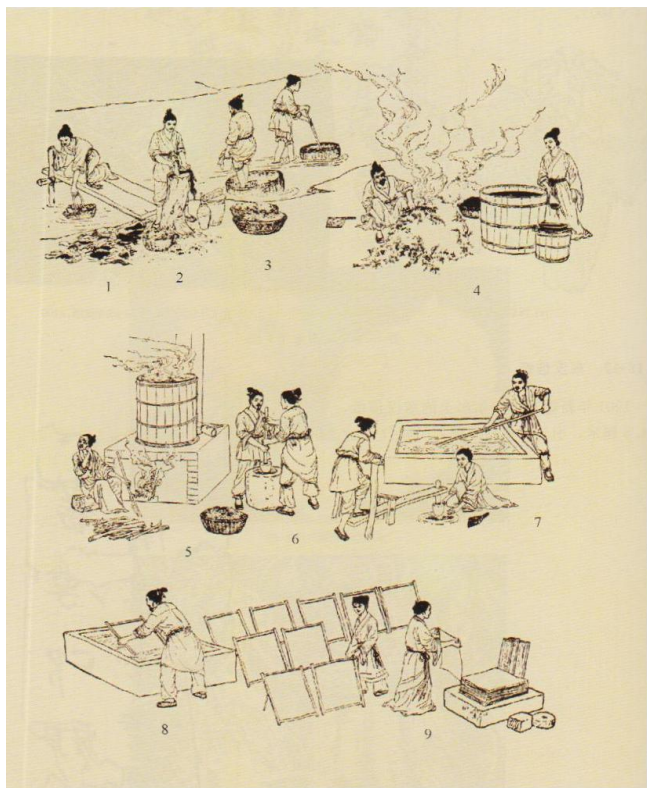
图 6-8 汉代造麻纸工艺流程
